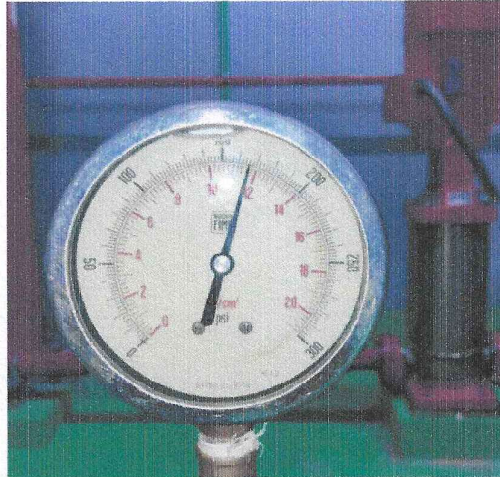
ทดสอบที่ 100 % ได้ค่าแรงดัน 168 PSI
