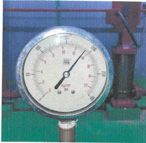
ทดสอบที่ 50 ได้ค่าแรงดัน 190 PSI
