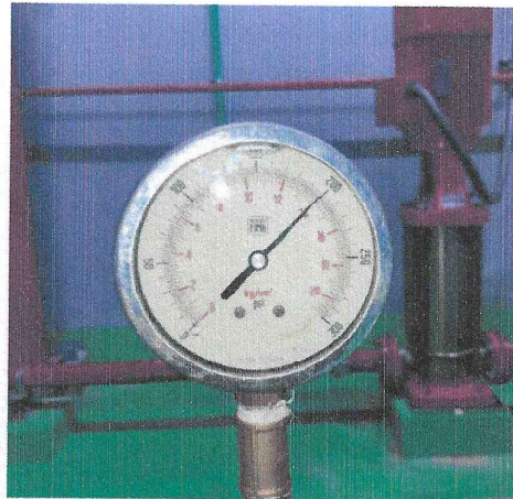
ทดสอบที่ 0 % ได้ค่าแรงดัน 200 PSI
